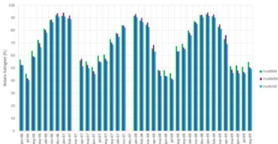
Figur 3.47 Månadsmedelvärden för relativ fuktighet (%) från tre sensorer mot norr med ånggenomsläppligt material på råsponten.
